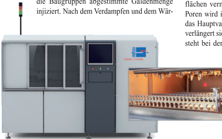
Abb. 6: Eine Condenso-Lötanlage nach dem Injektionsprinzip mit der Prozesskammer inklusive Warenträger
